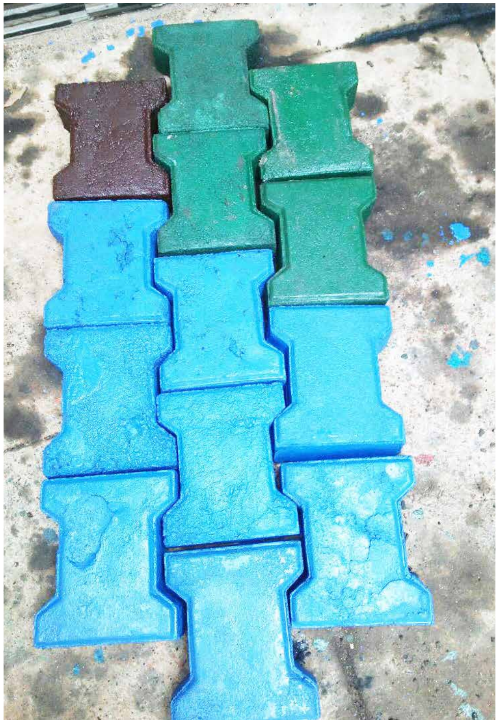
Des déchets ménagers recyclés. On peut en déduire des pavés ou autres objets
