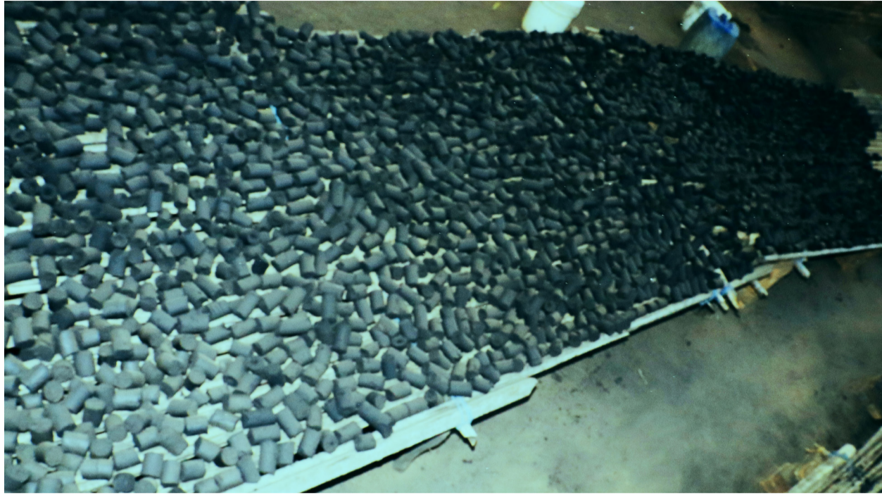
Depuis 2021, Apollinaire Ndikumusabo s'est lancé dans la fabrication de briquettes à partir de déchets provenant d'arbres, d'herbes, de papiers et d'autres types de déchets non plastiques.
